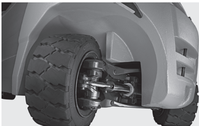
Маневренный и устойчивый благодаря высокой самоустанавливающейся опоре
